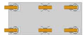
Vier Lenk- und zwei Bockrollen gleicher Bauhöhe
